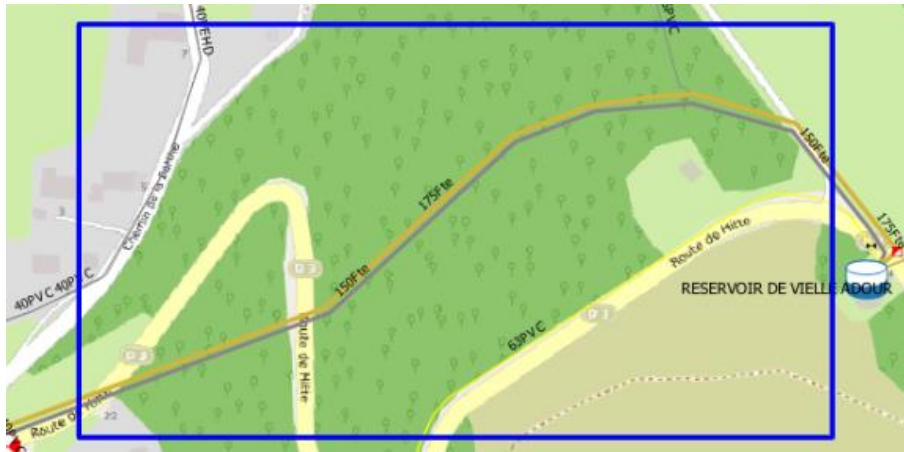
Exemple de la distribution à travers bois du réservoir de Vielle-Adour
